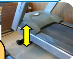
ランニングマシンは、屋外で運動するよりも運動量が減少します。マシンの傾斜を3%つけることで、屋外の平地と同等の運動量になります。
